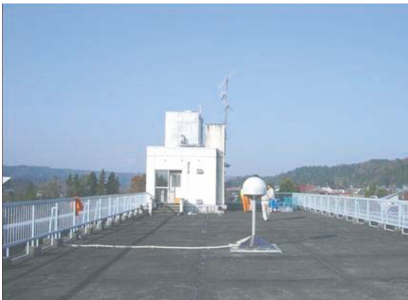
写真-3 下条小学校屋上に設置した GPS 機動連続観測点「M十日町」
