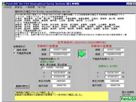
図-6 座標補正プログラム「PatchJGD」
