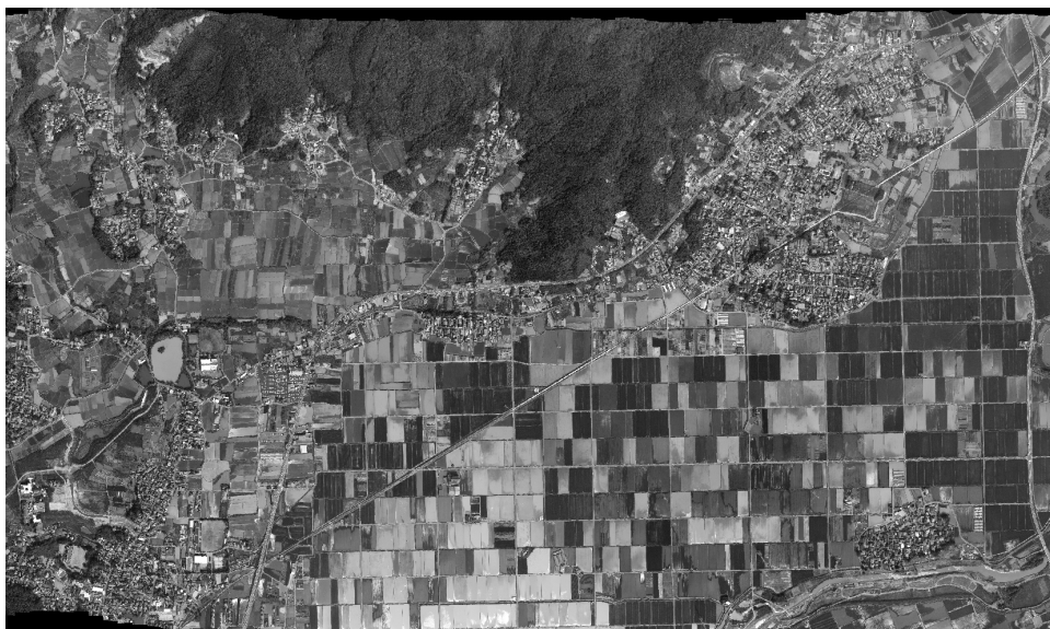
図-1 PRISM のシミュレーションデータと数値地図 50m メッシュ (標高) を使用して作成した正射画像
