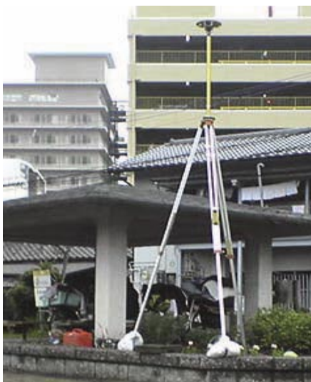
写真-4 街区基準点測量風景 (左: アンテナタワーによる GPS 観測 右: TS の観測 (現地最終確認検査))
