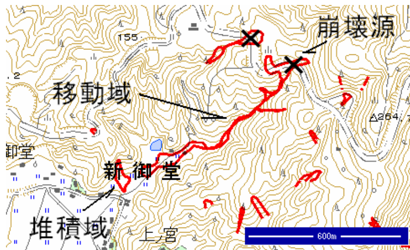
図4 垂水市上ノ宮地区の斜面崩壊
