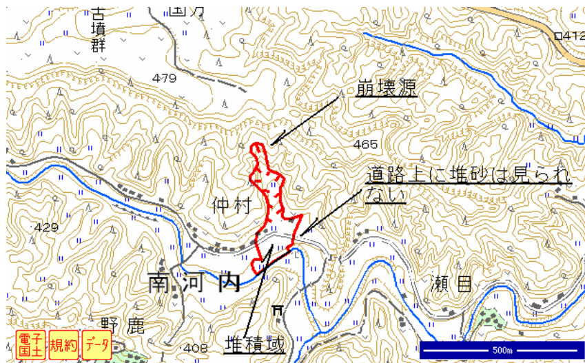
図 1 荻町南河内地区の斜面崩壊
