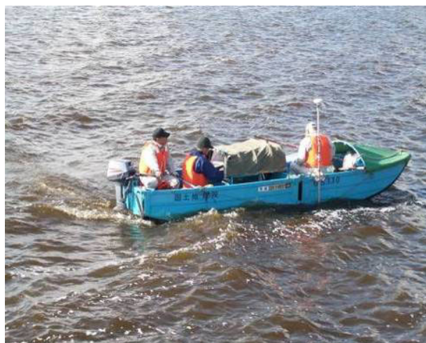
写真 - 5 音響測深機を用いた測深調査
