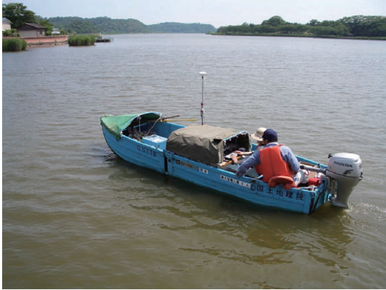
写真-7 音響測深機を用いた測深調査
