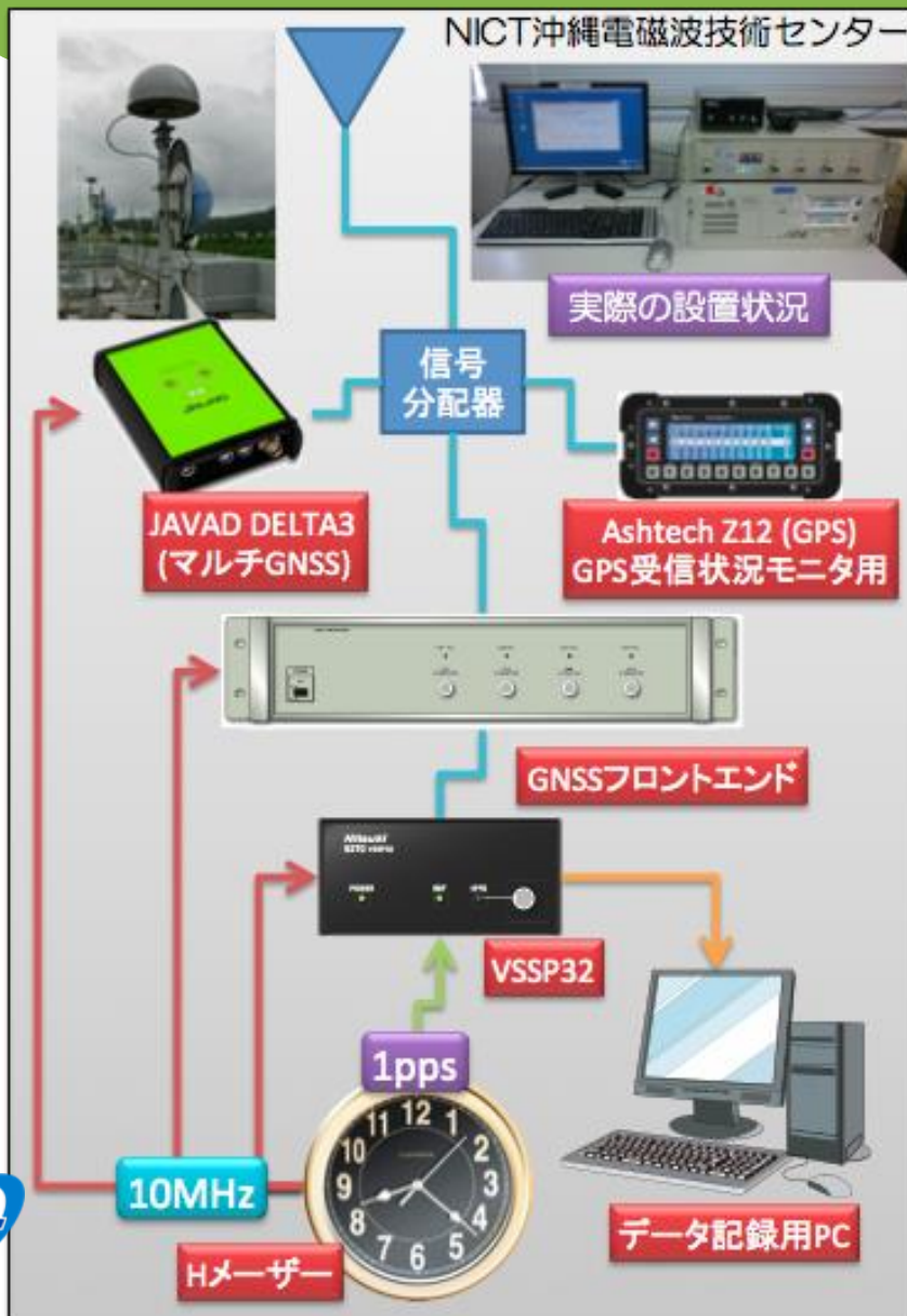
沖縄-つくばGNSS実験ブロック図
