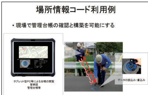
図-9 場所情報コードを書き込んだICタグ付きのマンホールでの利用例
