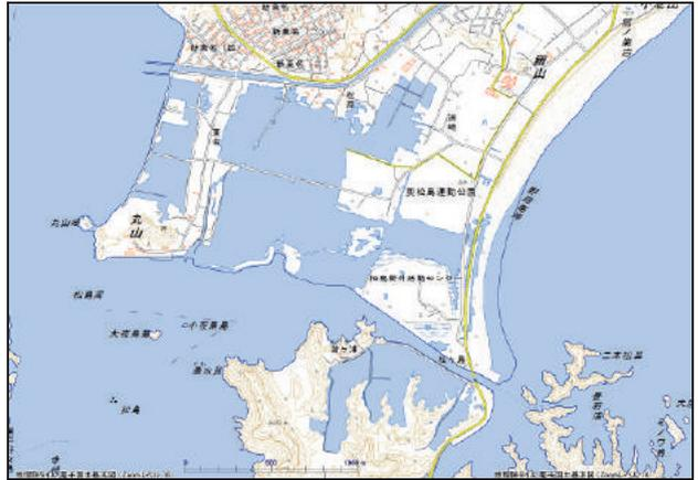
図-7 宮城県東松島市の海岸付近の電子国土基本図と東北地方太平洋沖地震の地殻変動による位置のずれを補正した地震前の海岸線データ(青線)の重畳
