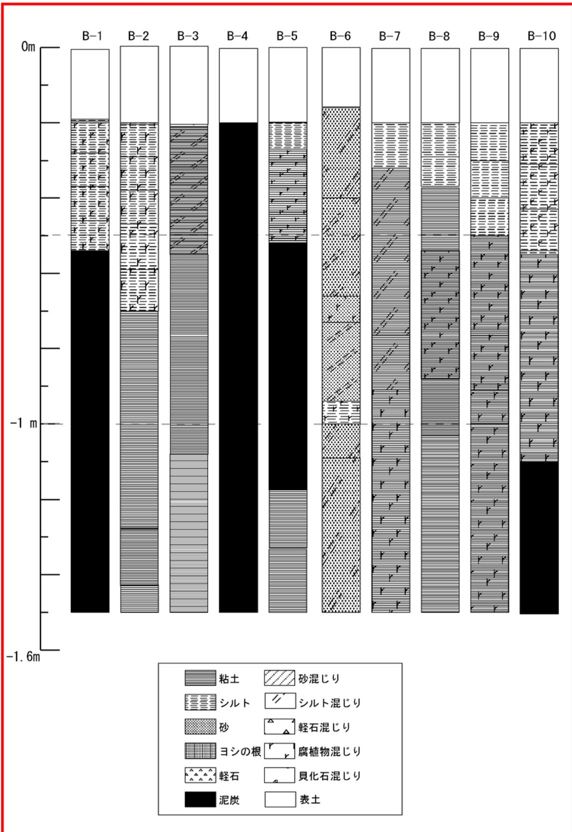
図 - 4 簡易ボーリング柱状図
