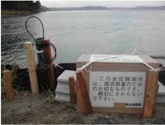
写真 - 5 火散布沼湖岸に設置した水位観測所 写真 - 6 音響測深機を用いた深浅測量の様子
