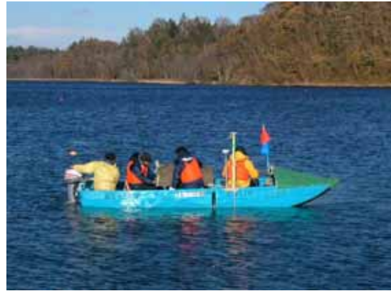
写真 - 5 火散布沼湖岸に設置した水位観測所 写真 - 6 音響測深機を用いた深浅測量の様子
