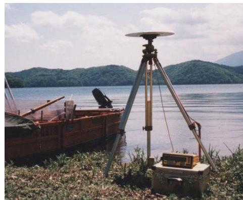
写真 1 GPS による基準点測量
