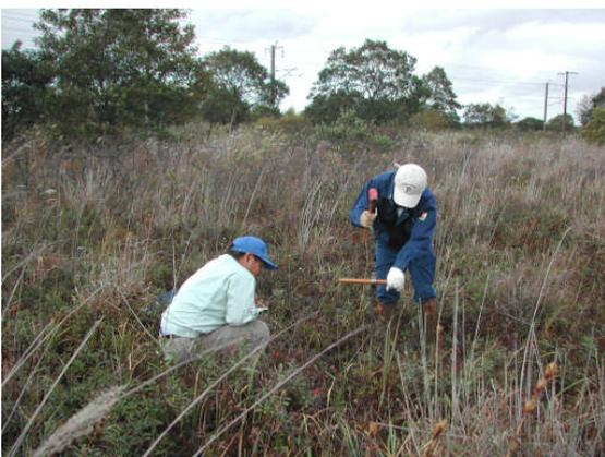
写真7 ボーリングステッキによる試料採取
