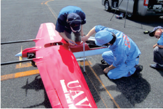
写真-2 UAV本体の発着地位置GNSS座標計測中
