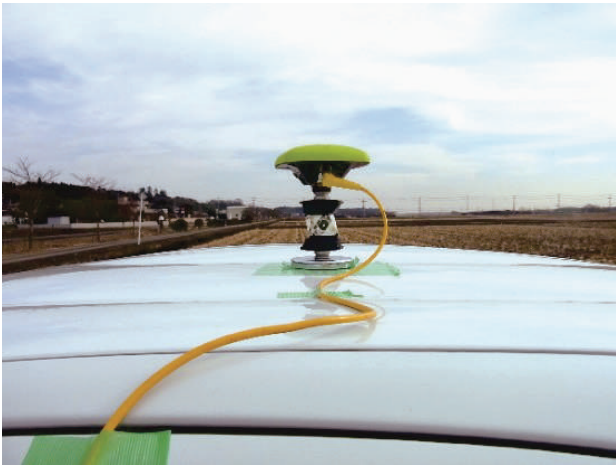
写真-5 自動車に GNSS アンテナ及び受信機を搭載した移動局
