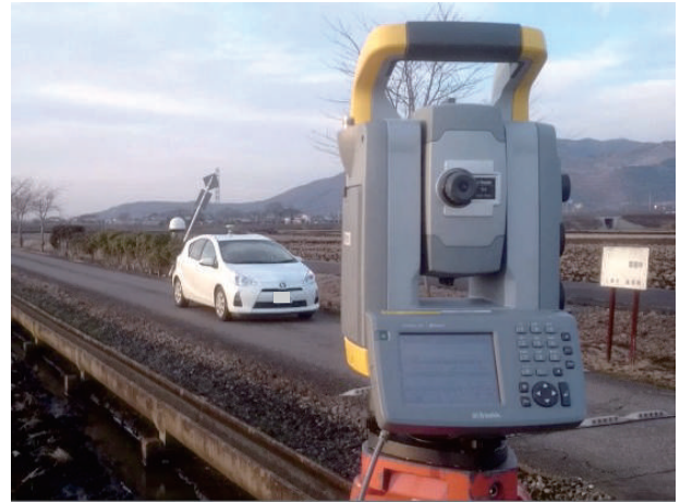
写真-7 TS による移動局の位置の観測
