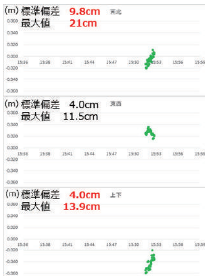
図-3 森の中を切り開いて道路を建設することを想定した観測点で得られた FIX 解
