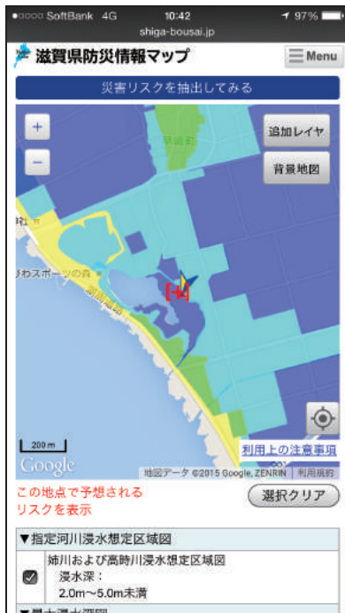
図-8 GNSS 機能により現在地のリスクを確認 出典：滋賀県防災情報マップ
