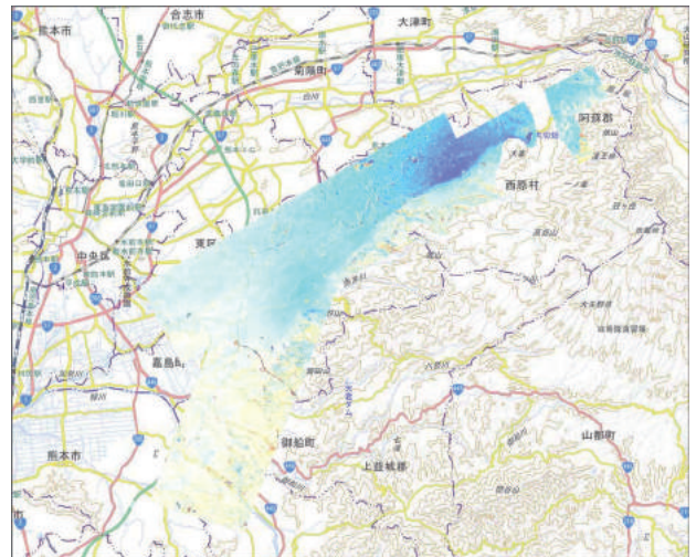
図-10 布田川断層帯・日奈久断層帯周辺標高差分段彩図
