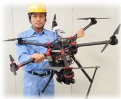
近年、測量での使用が増えている UAV（無人航空機）
