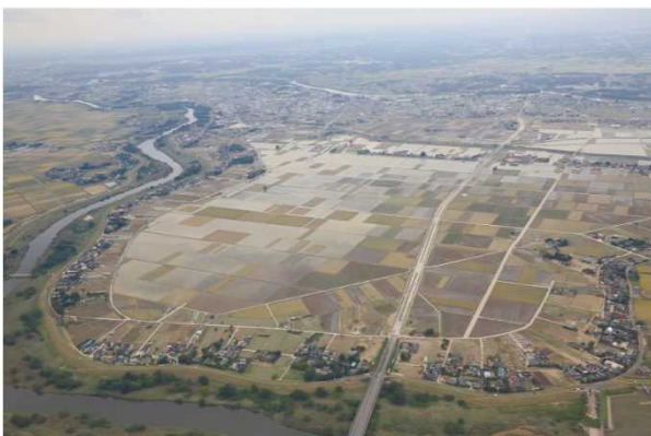
平成27年9月関東・東北豪雨で、鬼怒川決壊により浸水被害を受けた場所。洪水から6日経っていますが、後背湿地のため水が引いていません。
