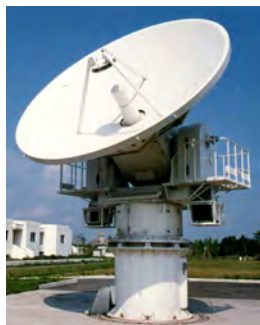
日本各地で観測を行った可搬型5mアンテナ
