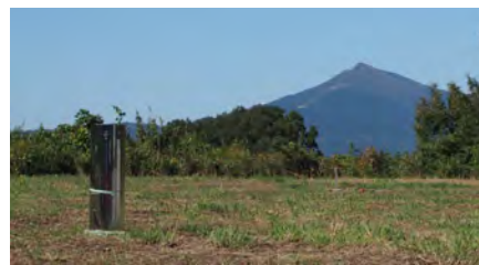
コロケーションピラー
