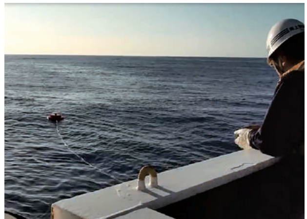
写真-8 測量船「昭洋」に係留した GNSS ブイ
