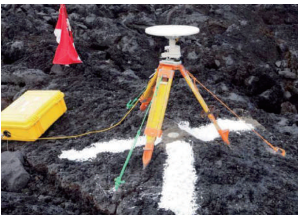
写真-4 三等三角点での GNSS 測量と設置した対空標識
