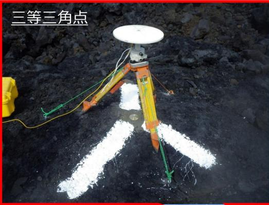
三角点を設置し、緯度・経度を測る（GNSS測量）
