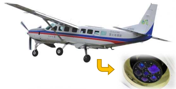
くにかぜIIIと下から見た航空カメラ（拡大） ※撮影しないときには窓穴を閉めています
