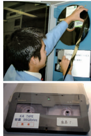
写真-4 Mark 4 システムで使用されたオープンリール型の磁気テープ（上）と K4 システムで使用された D1 テープ（下）。
