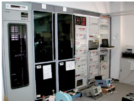
写真-3 つくば局の観測局舎に設置された Mark 4 システムの記録装置（写真中央にある黒色の装置）と K4 システムの記録装置（写真左）。
