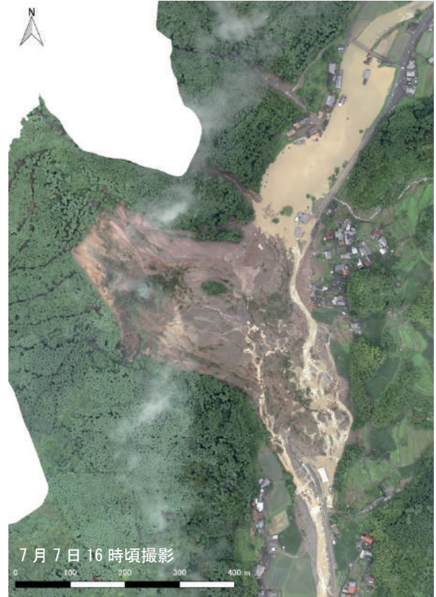
図-10 1秒毎の静止画を用いて SfM-MVS 解析で作成した正射画像（大分県日田市小野地区）
