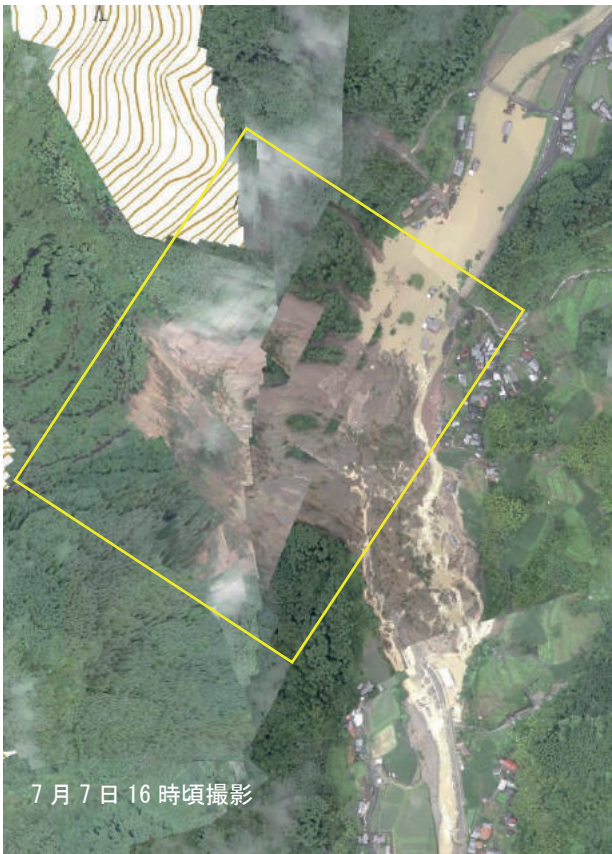
図-8 ヘリ画像処理システムでリアルタイムに地図に重ねて表示される画像（大分県日田市小野地区）
