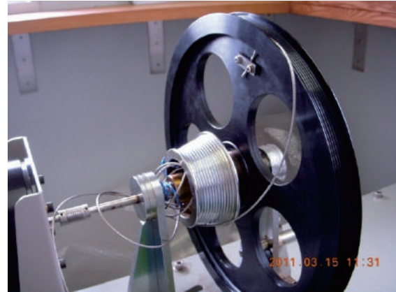
写真-2 ワイヤーが絡まり観測が停止した油壺験潮場
