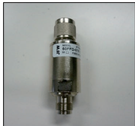
写真-1 電子基準点に導入したアッテネータ (DC パス型)
