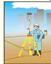
衛星測位システム(GNSS)を利用した効率的な測量で標高を決定
