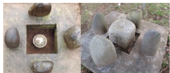
水準点金属標(左)と水準点標石(右)
