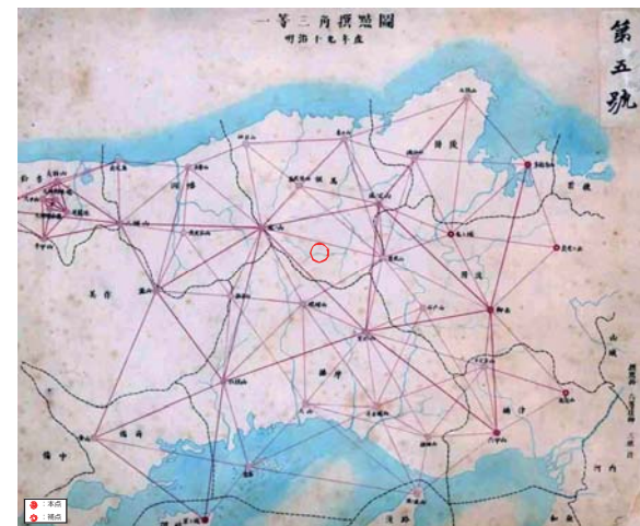
測量標(仮杭)が保管されていた地域の一等三角選点図(凡例を加筆)
