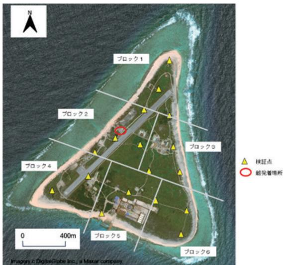
図-1 固定翼 UAV の離発着場所、飛行ブロック及び検証点の位置
