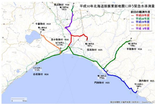
図-11 緊急水準測量路線図
