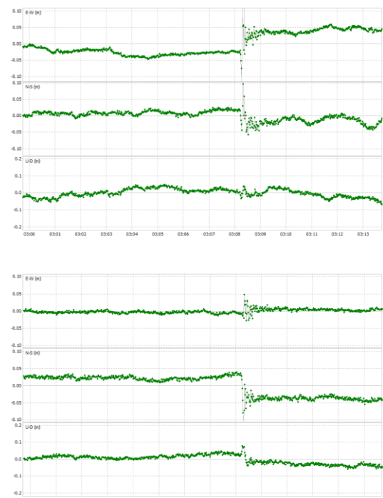
図-3 後処理1秒解析による座標成分の時系列（上：電子基準点「厚真」、下：「門別」）
