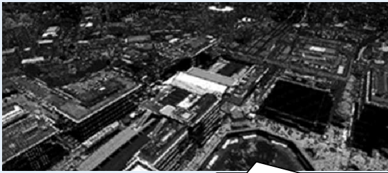
3次元地図の基盤となる 地形と構造物の点群データ
