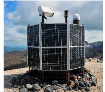
GNSS火山変動リモート観測
