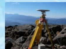
三角点とGNSS測量
